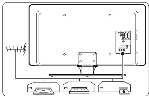
Используйте разъемы на задней панели телевизора, чтобы подключить антенну и такие устройства, как проигрыватель дисков высокой четкости, DVD проигрыватель или видеомагнитофон.
