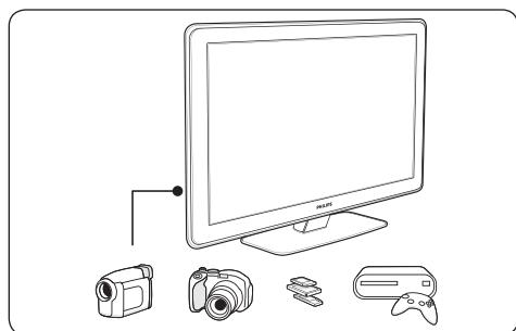
Используйте боковые разъемы телевизора для подключения мобильных устройств, таких как камера или современная игровая приставка. Также вы можете подключить наушники или устройство памяти USB.
