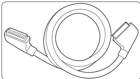
SCART сочетает аудио и видеосигналы в одном кабеле. Аудиосигналы передаются в режиме стерео, а видеосигнал может быть композитным или S-Video. SCART не поддерживает видео высокого разрешения и является аналоговым. К телевизору прилагаются два разъема SCART, EXT 1 и EXT 2.
