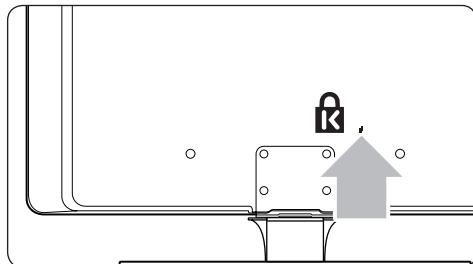
При установке защитного замка от кражи Kensington (который не входит в комплект) разместите телевизор на будущем месте расположения (например, на столе), где есть возможность закрепить замок.
