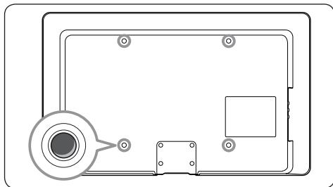
2. Закрепите плату/кронштейн при помощи четырех гаек, располагая прилагающиеся планки между платой/кронштейном и гайками.
