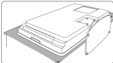
2. При помощи крестообразной отвертки (не входит в комплект) отвинтите 4 винта, которые закрепляют телевизор на подставке.
