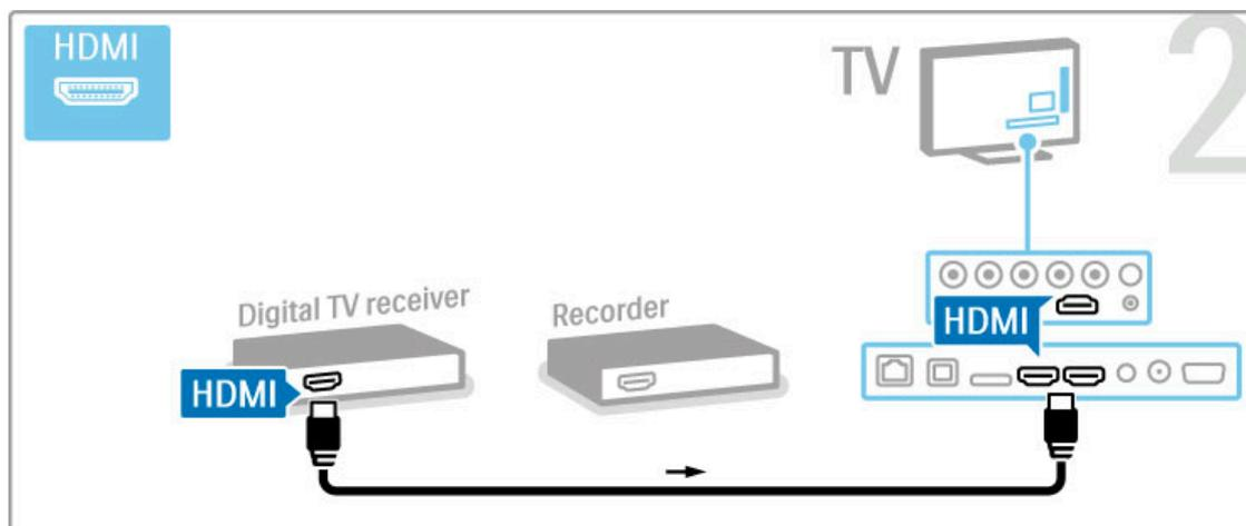
Infine, utilizzare un cavo HDMI per collegare il televisore al registratore disco.
