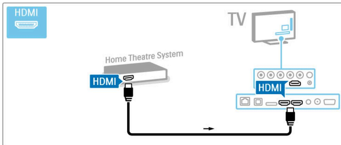
Se si utilizzano i collegamenti HDMI-ARC sia sul televisore che sul dispositivo, non sono necessari altri cavi. In caso contrario, proseguire la lettura.
