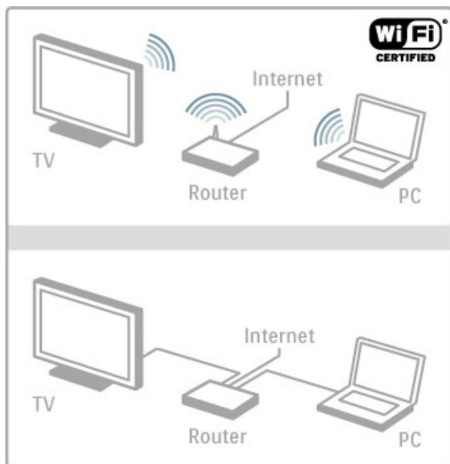
Si desea realizar una conexión mediante cable al router, necesitará un cable de red (Ethernet).
