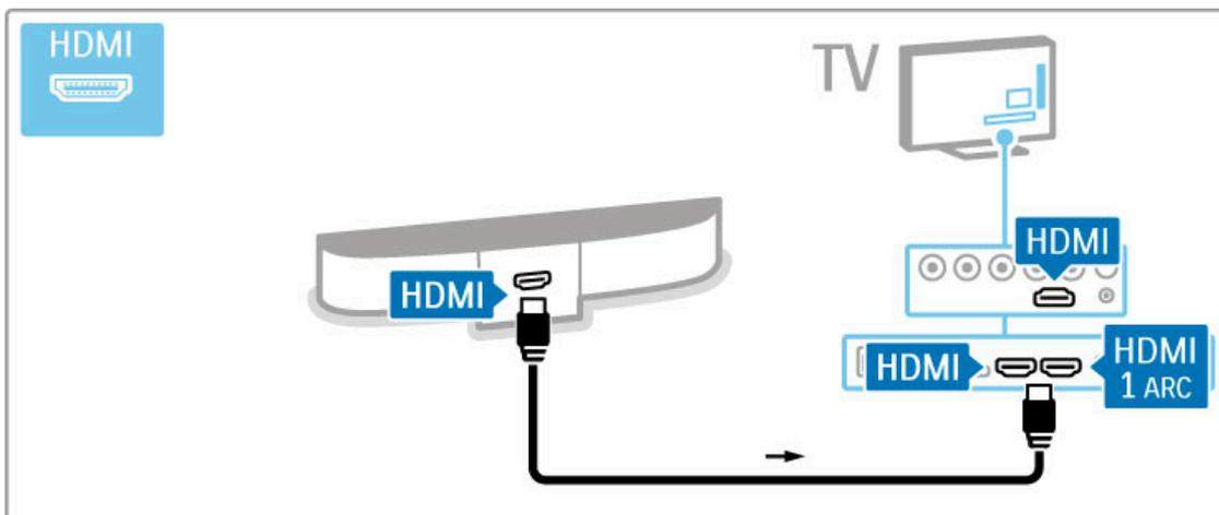
Si no utiliza conexiones HDMI-ARC, utilice también un cable de audio digital (óptica).
