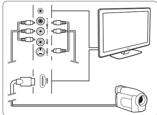
Подключения на задней панели ТВ
