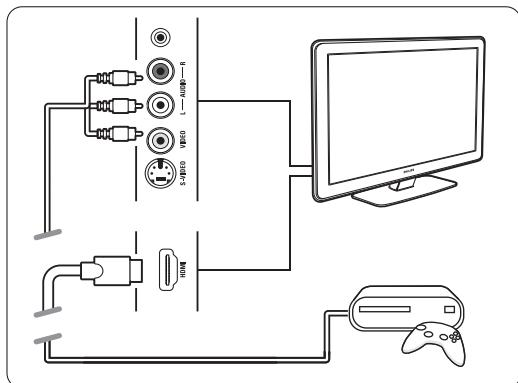
Подключения на задней панели ТВ
