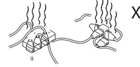
احرص على تفادي توصيل أجهزة كثيرة للغاية بنفس مقبس مصدر التيار الرئيسي، حيث قد يؤدي ذلك إلى إفراط التحميل مما يتسبب في نشوب حريق أو التعرض لصدمة كهربائية.
