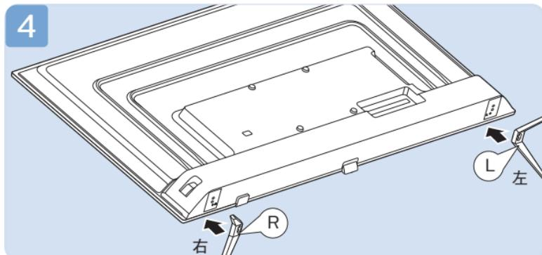
\*将底座按照图示对齐放置(注意区分左右支撑), R、L在底座上有标识。
