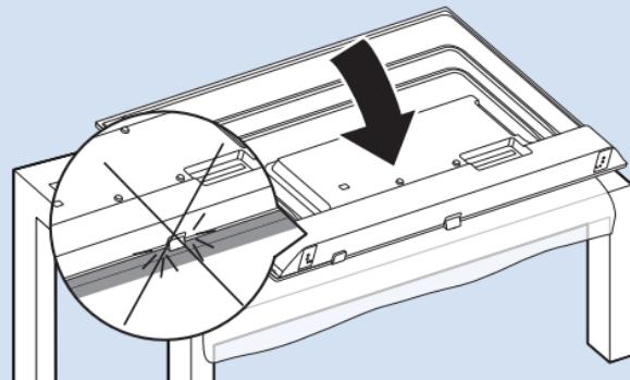
\*请将电视机底部边缘靠近台面边缘，将下巴放置于台面外。
