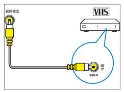
④ AV输入(视频/音频输入) DVD播放机或游戏机等模拟或数字设 备中的模拟音频视频输入。
