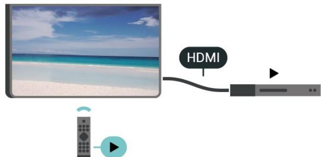
HDMI CEC (Consumer Electronic Control) จะต้องเปิดอยู่บนทีวีและอุปกรณ์ที่มีการเชื่อมต่อ
