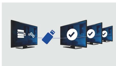
Proporciona a capacidade de copiar facilmente todas as definições de canais e de programação de um televisor para outro em menos de um minuto. A funcionalidade garante uniformidade entre televisores e reduz de forma significativa o tempo e os custos de instalação.
