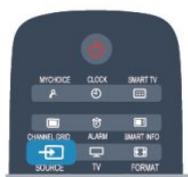
Sobald das Gerät angeschlossen ist, kann das Gerät über die Fernbedienung des Fernsehers gesteuert werden. Die Tasten **↑** und **OPTIONS** sowie einige weitere Fernsehortasten werden nicht an das Gerät weitergeleitet.
