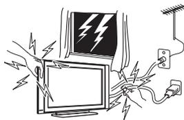
Como medida de seguridad, no toque ninguna parte del televisor, el cable de alimentación o el cable de la antena durante las tormentas eléctricas.
