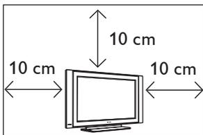
Deje al menos 10 cm desde cada lado del televisor para permitir una ventilación adecuada. Coloque el televisor en una superficie estable y nivelada. No cubra nunca las ranuras de ventilación del televisor con paños u otros materiales. Esto podría causar un sobrecalentamiento. No inserte nada en los agujeros de ventilación. Si algún objeto metálico o inflamable se introduce en estos agujeros, esto podría causar un incendio o una electrocución.
