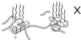
No conecte muchos equipos sobre la misma línea de corriente eléctrica, ya que la sobrecarga resultante podría causar un incendio o una electrocución.
