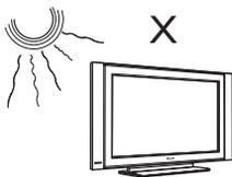
No coloque el televisor bajo la luz solar directa o cerca de fuentes de calor.
