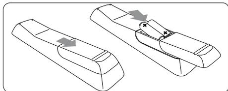
2. Introduza as duas pilhas fornecidas (Tamanho AAA, Tipo LR03). Certifique-se de que os pólos + e - das pilhas estão correctamente alinhados com as marcas existentes no interior da caixa.
