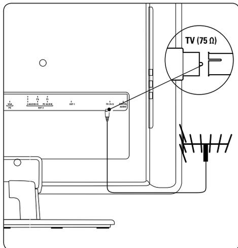
2. Ligue uma extremidade de um cabo de antena (não incluído) ao conector da **TV ANTENNA**. Utilize um adaptador se o cabo de antena não for adequado.
