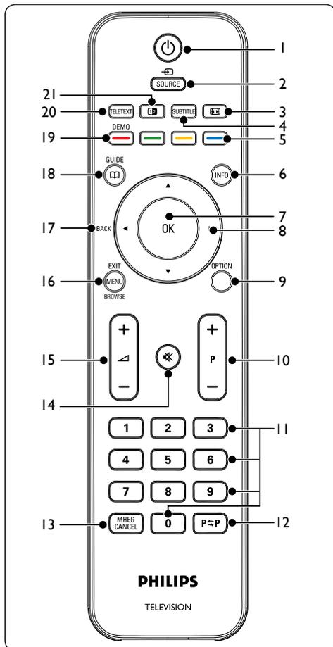
1. Liga a TV a partir do modo de standby ou volta para o modo de standby.
