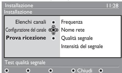
3. Premere il tasto ▼ per selezionare **Prova ricezione**, quindi premere il tasto ►. Sono visualizzati la frequenza del programma, il nome della rete, la qualità del segnale e l'intensità del segnale.
