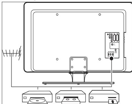
Verwenden Sie die Anschlüsse auf der Rückseite des Fernsehgeräts, um die Antenne und feste Geräte wie HD-Disc-Player, DVD-Player oder Videorecorder (siehe 'Anschließen von Geräten' auf Seite 45) anzuschließen.
