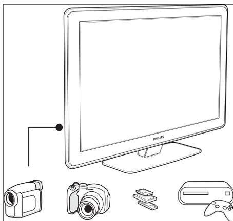
Verwenden Sie die seitlichen Anschlüsse des Fernsehgeräts, um mobile Geräte wie eine Kamera oder eine HD-Spielekonsole anzuschließen. Sie können auch einen Kopfhörer oder ein USB-Speichergerät anschließen.
