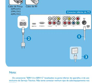
Nota: Os conectores **SERV U** e **SERV C** localizados na parte inferior do aparelho, são de uso exclusivo do Serviço Técnico. Não tente conectar nenhum tipo de cabo/equipamento nos mesmos.
