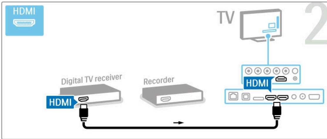
Τέλος, χρησιμοποιήστε ένα καλώδιο HDMI για να συνδέσετε τη Συσκευή εγγραφής δίσκων στην τηλεόραση.
