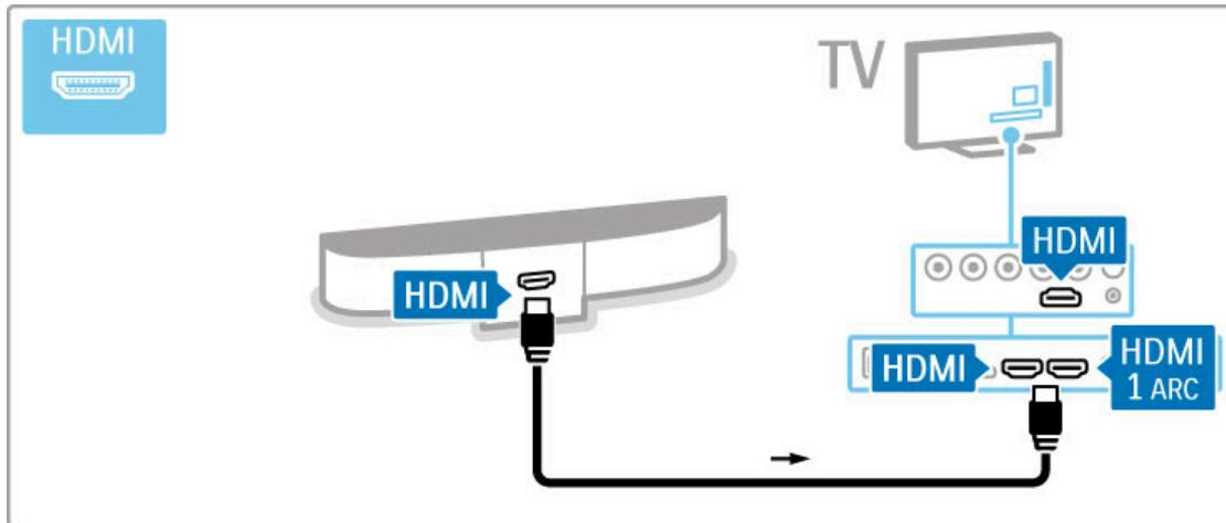
Αν χρησιμοποιείτε συνδέσεις HDMI-ARC στην τηλεόραση και στη συσκευή, δεν απαιτείται επιπλέον καλώδιο. Διαφορετικά, διαβάστε τις οδηγίες που ακολουθούν.
