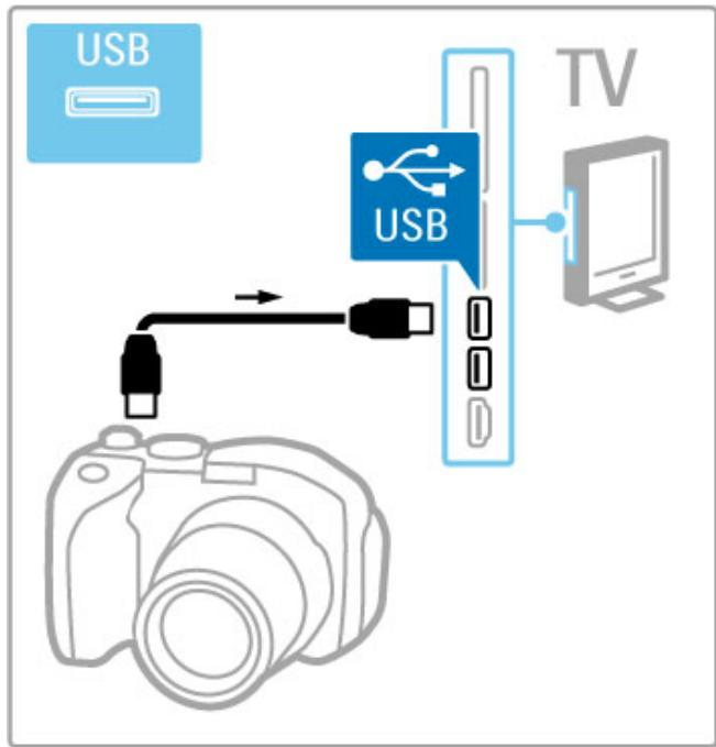
Αν η λίστα με το περιεχόμενο της φωτογραφικής μηχανής δεν εμφανιστεί αυτόματα, ενδέχεται να χρειάζεται ρύθμιση της φωτογραφικής μηχανής σας για τη μεταφορά περιεχομένου μέσω του πρωτοκόλλου μεταφοράς εικόνων (PTP – Picture Transfer Protocol). Ανατρέξτε στο εγχειρίδιο χρήσης της ψηφιακής φωτογραφικής μηχανής.
