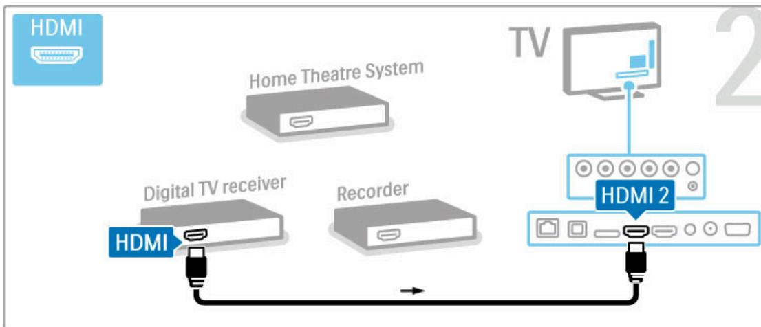
Στη συνέχεια, χρησιμοποιήστε ένα καλώδιο HDMI για να συνδέσετε τη Συσκευή εγγραφής δίσκων στην τηλεόραση.
