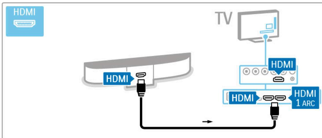
Αν δεν χρησιμοποιείτε σύνδεση HDMI-ARC, προσθέστε ένα καλώδιο ψηφιακού ήχου (ομοαξονικό - cinch).
