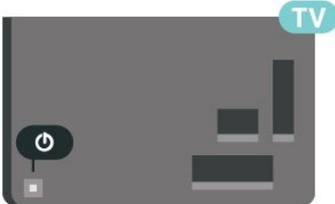
电视进入待机模式后，按遥控器上的
