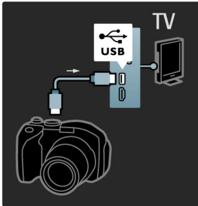
Ако списъкът със съдържанието на фотоапарата не се появява автоматично, може би трябва фотоапаратът ви да се настрои за прехвърляне на съдържанието с PTP (Picture Transfer Protocol - Протокол за прехвърляне на снимки). Прочетете ръководството за потребителя на цифровия фотоапарат.
