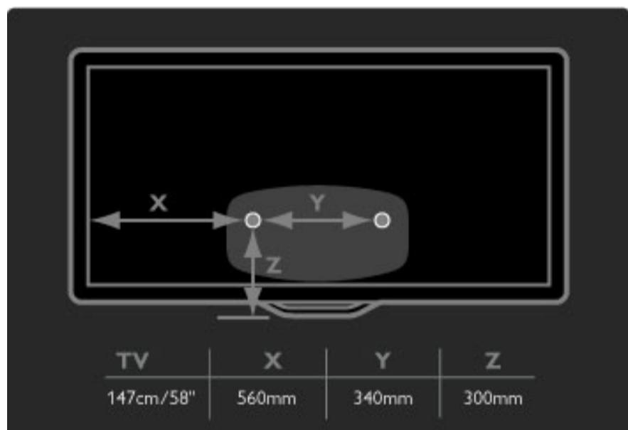
Fiksirajte 2 diska za montažu. Koristite zavrtnje čiji prečnik nije veći od 6 mm.
