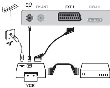
Κάνετε τις συνδέσεις που φαίνονται στο διπλανό σχέδιο. Χρησιμοποιήστε ένα καλώδιο σύνδεσης ενεωβύβμα καλής ποιότητας.
