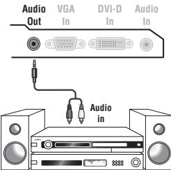
Pour le raccordement à une chaîne Hi-fi, utilisez un cordon de liaison audio et connectez la sortie son **Audio out** du téléviseur à une entrée "AUDIO IN" "L" et "R" de la chaîne Hi-fi.
