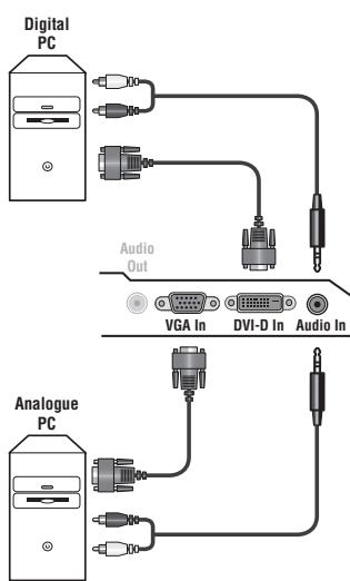
Sluit de schermuitgang van uw computer aan op de **PC input VGA In** of **DVI-D In** ingang van de TV.
