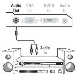
Om een hi-fi systeem aan te sluiten, dient u een audiokabel te gebruiken en de **Audio out** uitgangen van het TV toestel aan te sluiten op de ingangen "AUDIO IN" "L" en "R" van de versterker van uw hi-fi.
