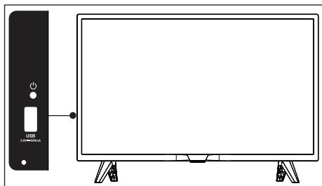
① (电源键)：切换产品待机/开机状态。必须拔下电源插头，本产品才会完全断电。
