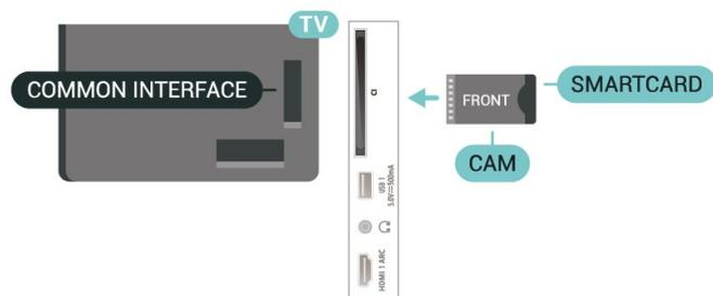
Po zapnutí televízora môže aktivovanie modulu CAM niekoľko minút trvať. Ak je vložený modul CAM a sú zaplatené príslušné poplatky za predplatné (rôzne druhy predplatného sa môžu líšiť), môžete pomocou prístupovej karty sledovať kódované kanály.
