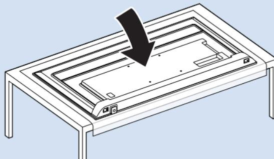
\*请将电视机底部边缘靠近台面边缘，将下巴放置于台面外约5cm。
