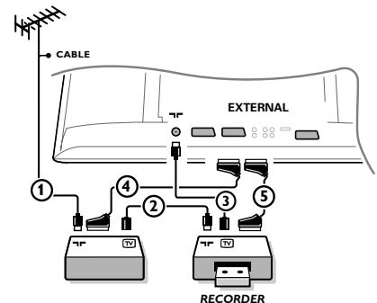
① Συνδέστε τα καλώδια κεραίας ①, ② και ③ όπως φαίνεται στο σχήμα (εφόσον η περιφερειακή συσκευή διαθέτει είσοδο/έξοδο κεραίας τηλεόρασης).
