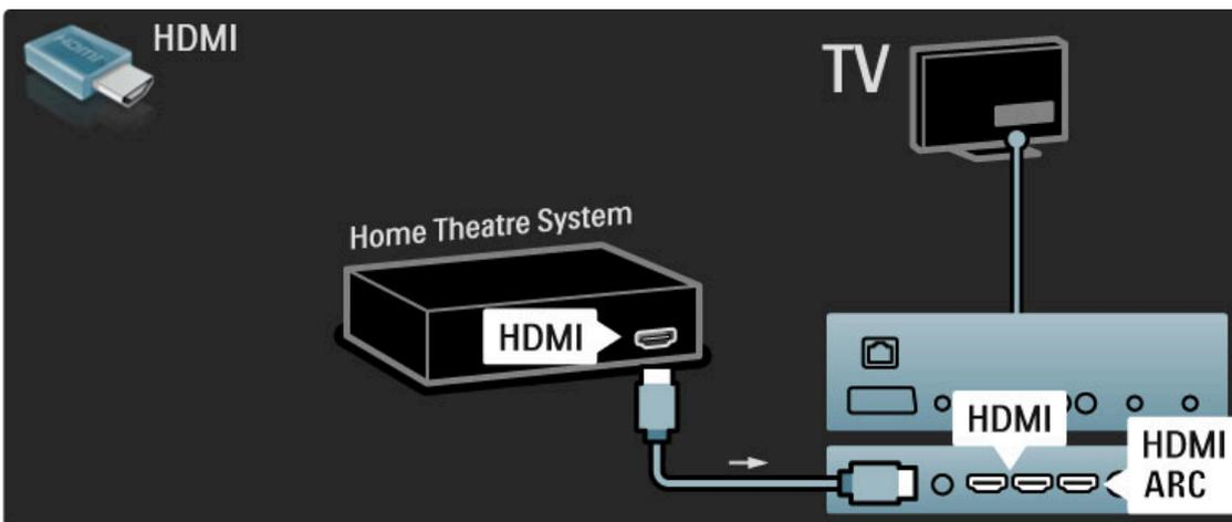
Si no utiliza la conexión HDMI-ARC, utilice también un cable de audio digital (coaxial cinch).
