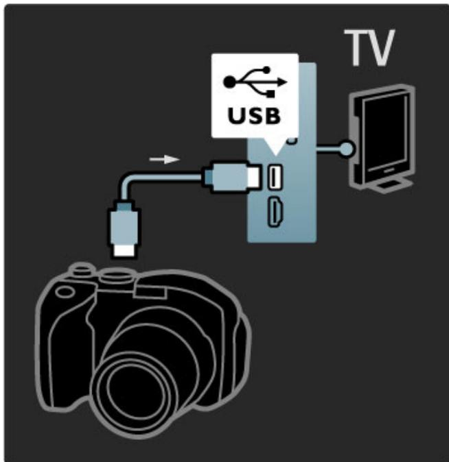
Si no aparece automáticamente la lista con el contenido de la cámara, puede que haya que configurar la cámara para transferir su contenido con el protocolo de transferencia de imágenes (PTP, del inglés Picture Transfer Protocol). Consulte el manual de usuario de la cámara de fotos digital.
