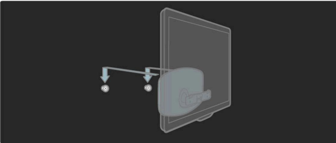
Para nivelar el televisor, tire de la parte inferior del televisor hacia usted moviéndolo sobre los discos.
