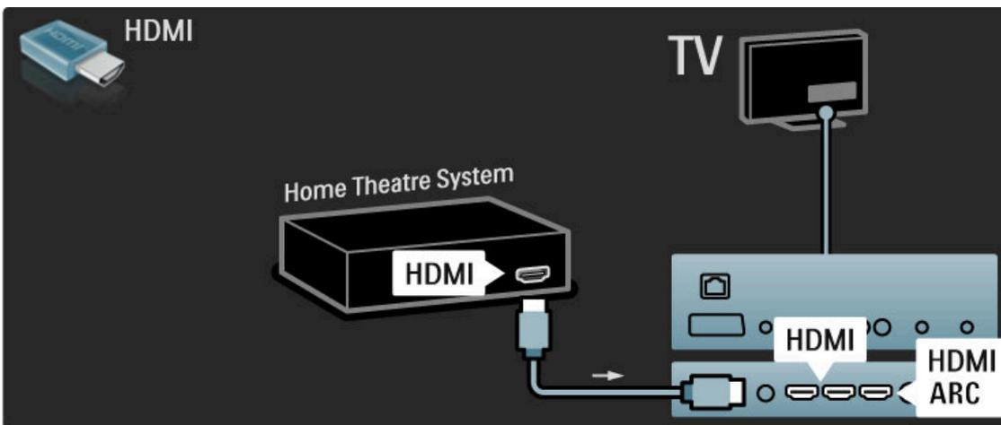
Si utiliza conexiones HDMI-ARC tanto en el televisor como en el dispositivo, no necesitará ningún otro cable. De lo contrario, siga leyendo.
