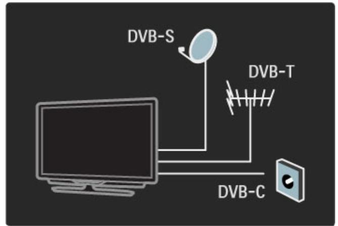
Junto a las entradas de TDT y TDC, el televisor cuenta con un receptor integrado de TDS que le permite conectar una antena de televisión por satélite y recibir **canales digitales por satélite**.
