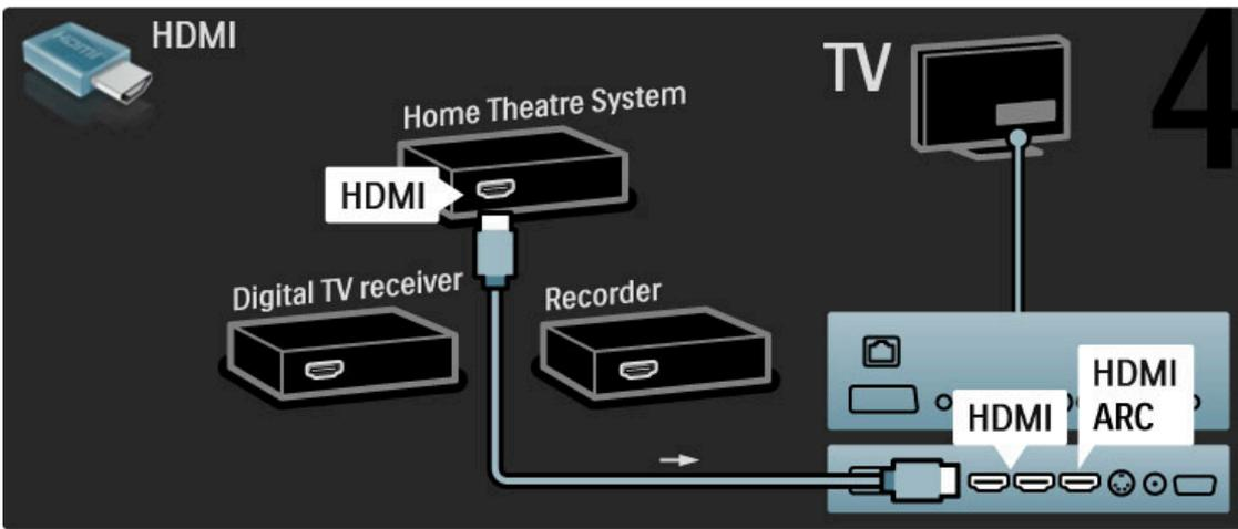
Si no utiliza la conexión HDMI-ARC en el televisor y el dispositivo, deberá utilizar también un cable de audio digital (coaxial cinch).
