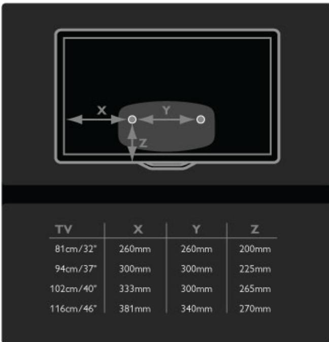
Fije los 2 discos de montaje utilizando tornillos de 6 mm de diámetro como máximo.
