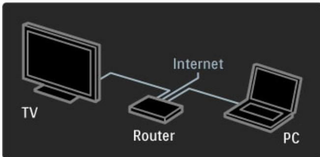
Si desea realizar una conexión mediante cable al router, necesitará un cable de red (Ethernet).
