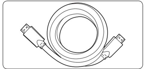
A ligação HDMI gera a melhor qualidade audiovisual possível. Os sinais de áudio e vídeo são combinados num cabo HDMI, constituindo uma interface digital descomprimida entre o televisor e os dispositivos HDMI. Deverá utilizar a ligação HDMI se pretende desfrutar de todo o esplendor do vídeo em Alta Definição. É também necessário utilizar cabos HDMI para activar a Philips EasyLink, como descrito na *Secção 7.5 Utilizar a Philips EasyLink*.
