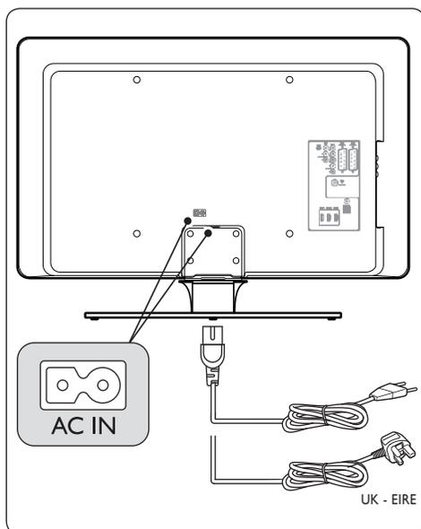
1. Identifique o conector de corrente eléctrica **AC IN** no painel posterior ou na base do televisor.
