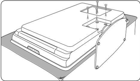
3. Separe o suporte do televisor. Coloque o suporte e os parafusos num local seguro para futura reinstalação.
