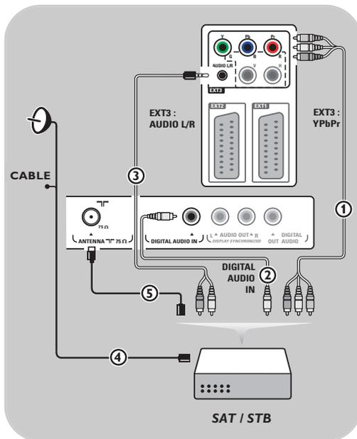
**Avvertenza** - Se si notano spostamenti delle immagini, colori errati, assenza di colore o immagini oppure diverse combinazioni di queste condizioni, verificare che i collegamenti siano corretti e che risoluzione e standard del segnale delle apparecchiature collegate siano impostati correttamente. Consultare il manuale dell'apparecchiatura.
