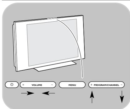
Nel caso in cui il telecomando si rompa o vada perduto, oltre alla possibilità di selezionare i canali e regolare il volume è possibile anche effettuare alcune modifiche di base delle impostazioni utilizzando i tasti posti sulla parte superiore del televisore.
