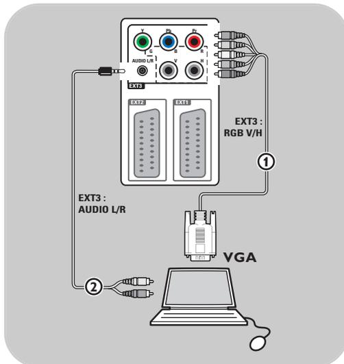
**PC dotati di connettore VGA**
