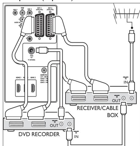
Pour recevoir des chaînes analogiques via l'antenne et enregistrer des émissions sur un lecteur/enregistreur de DVD et un récepteur (séparés), connectez trois câbles d'antenne et trois câbles péritel selon le schéma suivant :
