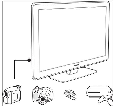
Utilisez les connecteurs latéraux du téléviseur pour les connexions aux appareils mobiles comme un appareil photo ou une console de jeux haute définition. Vous pouvez également brancher des écouteurs ou un périphérique de stockage USB.
