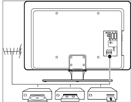
Les connecteurs arrière du téléviseur sont destinés à la connexion de l'antenne et de périphériques fixes, par exemple un lecteur de disques haute définition, un lecteur de DVD ou un magnétoscope (voir 'Connexion de périphériques' à la page 43).
