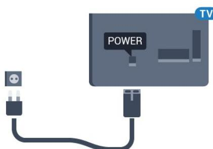
Αν και η τηλεόραση αυτή καταναλώνει ελάχιστη ενέργεια στην κατάσταση αναμονής, για εξοικονόμηση ενέργειας, συνιστάται να αποσυνδέετε το καλώδιο τροφοδοσίας, αν δεν σκοπεύετε να χρησιμοποιήσετε την τηλεόραση για μεγάλο χρονικό διάστημα.
