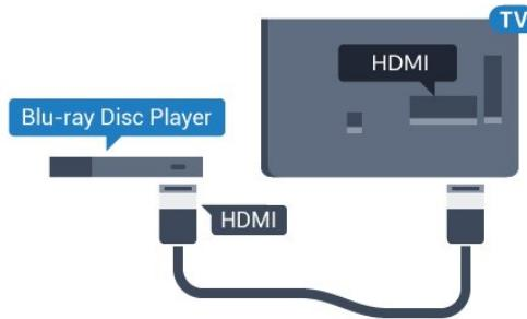
Αν η συσκευή αναπαραγωγής Blu-ray Disc διαθέτει EasyLink HDMI CEC, μπορείτε να χειρίζεστε τη συσκευή με το τηλεχειριστήριο της τηλεόρασης.
