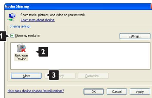
Pode abrir a janela **Settings** (Definições) para alterar definições da partilha em particular. Quando o ícone do dispositivo (o TV) tiver uma marca verde, clique em **OK**.
