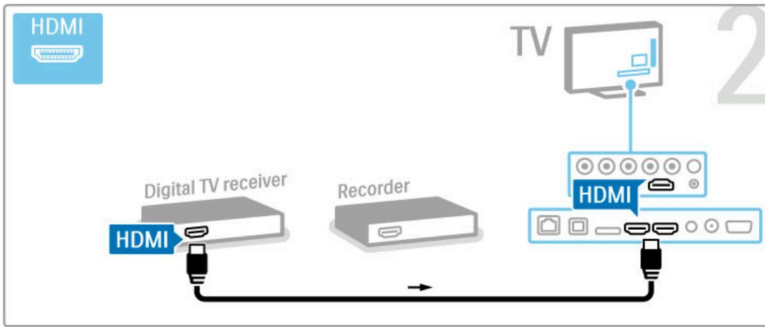
Τέλος, χρησιμοποιήστε ένα καλώδιο HDMI για να συνδέσετε τη Συσσκευή εγγραφής δίσκων στην τηλεόραση.
