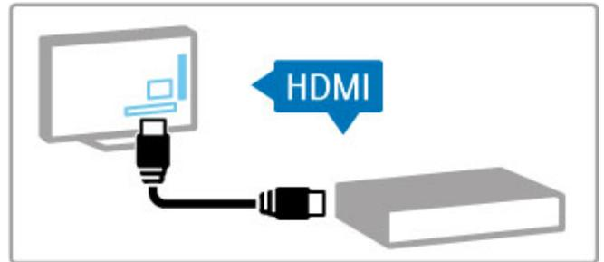
Χρησιμοποιήστε τη σύνδεση **HDMI™** για να συνδέσετε μια συσκευή αναπαραγωγής DVD, μια συσκευή Blu-ray Disc ή μια κονσόλα παιχνιδιών.
