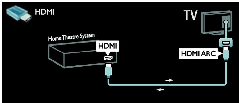
Com o HDMI ARC, você pode usar o Philips EasyLink para transmitir o áudio da TV direto para um dispositivo de áudio conectado, sem a necessidade de um cabo de áudio digital adicional.
