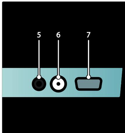
5. **AUDIO IN**: Entrada de áudio de dispositivos que requerem uma conexão de áudio separada, tal como um computador.
