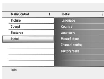
Daži pārraidītāji vai kabeļtelevīzijas tikli pārraida viņu pašu sakārtošanas parametrus (reģionu, valodu, utt.). Šajā gadījumā, norādīt Jūsu izvēli ar taustiņiem **ΛΛ** un apstipriniet ar **>**. Lai izslēgtu vai pātrauktu meklēšanu, spiediet taustiņu **MENU**. Ja netiek atrasta neviens programma, skatiet iespējamos risinājumus 19. lpp.
