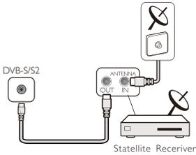
Schließen Sie das Kabel von der Satellitenantenne am Satellitenempfänger an.
