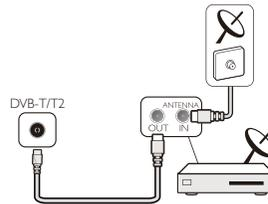
Haben Sie einen Digitalempfänger oder Rekorder, so schleifen Sie das Antennensignal durch den Digitalempfänger oder Rekorder zum Fernseher. Auf diese Weise können die Antenne und Digitalempfänger mögliche zusätzliche Kanäle zur Aufnahme an den Rekorder senden.
