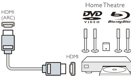
Verwenden Sie ein HDMI-Kabel zum Anschluss eines Heimkinosystems am Fernseher. Sie können einen Philips Soundbar oder ein Heimkinosystem mit integriertem Discplayer anschließen.
