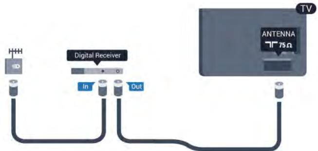
До връзките за антена добавете HDMI кабел, за да свържете цифров приемник (Set-top box) с телевизора. Или можете да използвате SCART кабел, ако цифровият приемник няма HDMI връзка.
