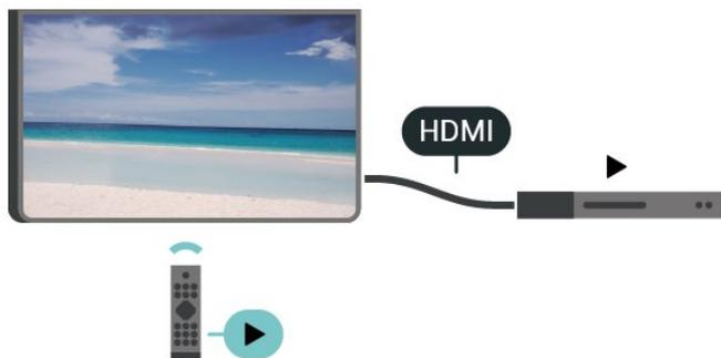
O HDMI-CEC (Consumer Electronic Control – Controlo de Electrónica de Consumo) tem de estar activado tanto no televisor como no dispositivo ligado.
