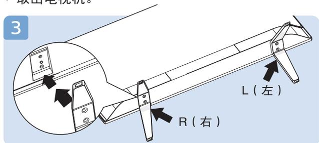
\* 将底座按照图示对齐放置（注意区分左右支撑），“R”、“L”在底座上有标识。
