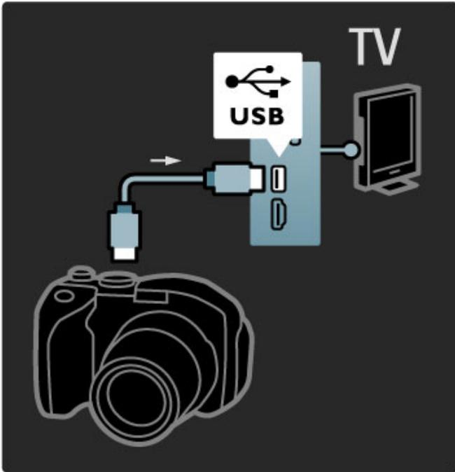
Камера мазмұнының тізімі автоматты түрде көрсетілмесе, мазмұның тасымалдау үшін, камераның PTP (Сурет тасымалдау протоколы) арқылы реттелуі қажет болуы мүмкін. Сандық фотокамераның пайдаланушы нұсқаулығын оқыңыз.
