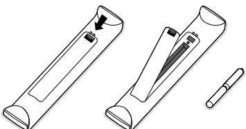
Sätt i de 2 medföljande batterierna av typ R6 och var noga med att vända dem rätt.
