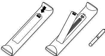
Inserire le due pile di tipo R6 (fornite) facendo attenzione alla polarità. Verificare che il selettori di modo sia sulla posizione TV.
