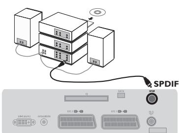
Um ein Hi-Fi-System anzuschließen, verwenden Sie ein Audioanschlusskabel und verbinden den SPDIF-Ausgang des Fernsehgeräts mit einem DIGITAL IN-Eingang am Verstärker (Verstärker mit Koaxial-Digitaleingang).
