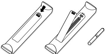
Coloque las dos pilas de tipo R6 (suministradas con el equipo) asegurándose de respetar la polaridad indicada.
