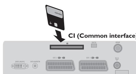
Am Common Interface-Steckplatz kann ein CAM (Conditional Access Module) und eine Smartcard angeschlossen werden. Für weitere Informationen über diese Module wenden Sie sich bitte an Ihren Serviceprovider.
