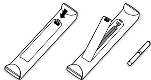
Legen Sie die zwei R6-Batterien (geliefert) ein und stellen Sie sicher, dass deren Pole korrekt angeordnet sind.
