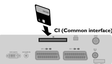
Para conectarlo a un sistema de alta fidelidad, utilice un cable de conexión de audio digital y conecte la salida "SPDIF" a una entrada "DIGITAL IN" en el amplificador (amplificador con entrada digital coaxial).
