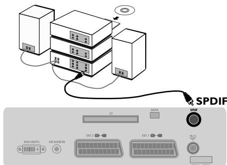
Om TV-apparaten skall anslutas till en hifi-anläggning används en ljudkabel. Anslut uttagen **TV-apparaten "SPDIF"-utgång** och en **"DIGITAL IN"-ingång** på förstärkaren (förstärkare med koaxial digitalingång).
