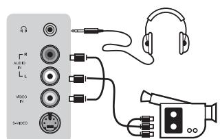
Nehmen Sie die hier abgebildeten Anschlüsse vor. Mit der Taste **AV** wählen Sie **AV/S-VHS3** aus. Für ein Monogerät schließen Sie das Tonsignal an den Eingang **AUDIO L** (oder **AUDIO R**) an. Der Ton wird automatisch auf den linken und rechten Lautsprechern des Geräts ausgegeben.
