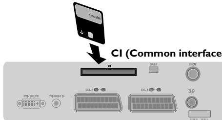
Ett anpassat gränssnitt är tillgängligt för anslutning av en CAM (conditional access-modul) och ett kort (smartcard). Kontakta din servicegivare om du önskar mer information om de här modulerna.
