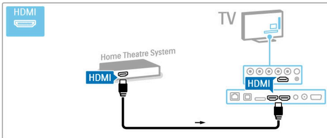
Ako ne koristite HDMI-ARC vezu, dodajte digitalni audio kabl (optički).
