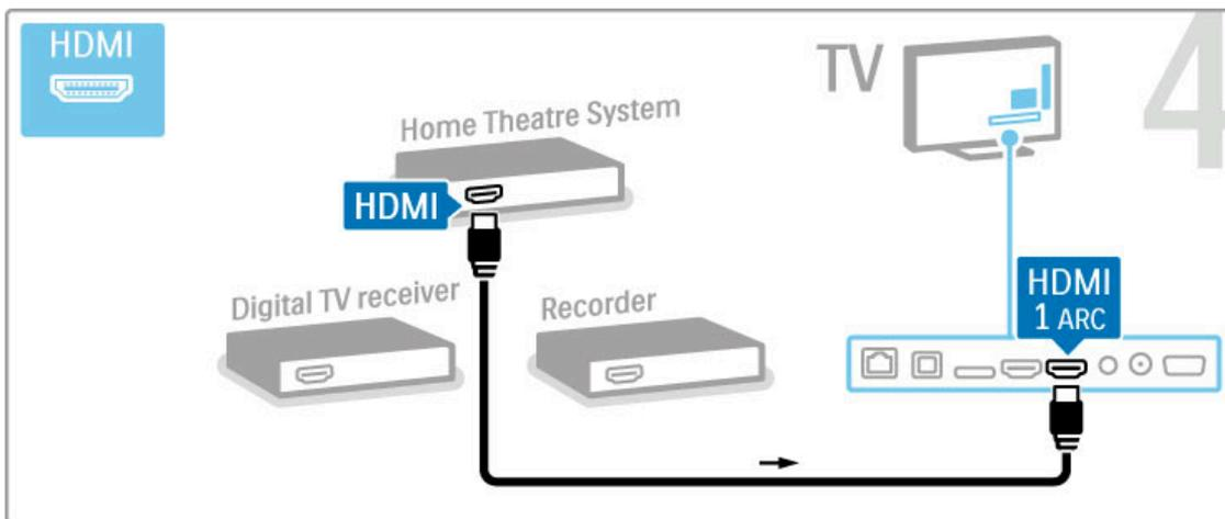
Ako ne koristite HDMI-ARC vezu na televizoru i na uređaju, dodajte digitalni audio kabl (optički).
