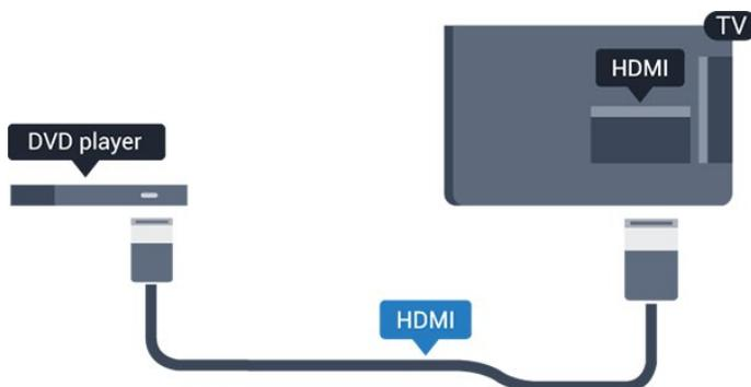
Si el reproductor de DVD está conectado mediante HDMI y dispone de EasyLink CEC, puede controlar el reproductor con el mando a distancia del televisor.
