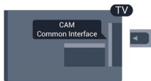
Utilice la ranura de interfaz común del televisor para insertar la tarjeta del CAM.
