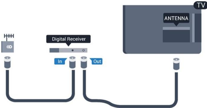
Junto al conector de la antena, añada un cable HDMI para conectar el receptor digital al televisor. También puede utilizar un cable SCART si el receptor digital no tiene conexión HDMI.
