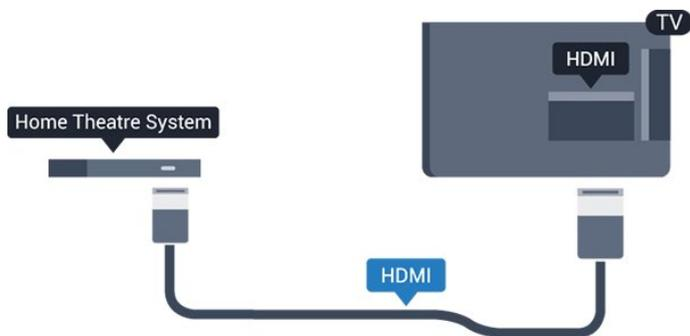
Si el sistema de cine en casa no dispone de conexión HDMI ARC, añada un cable óptico de audio (Toslink) para enviar el sonido de la imagen del televisor al sistema de cine en casa.
