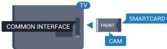
Utilice la ranura de interfaz común del televisor para insertar la tarjeta del CAM.
