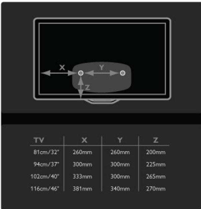
Прикріпіть 2 опорні диски. Використовуйте гвинти діаметром щонайбільше 6 мм.
