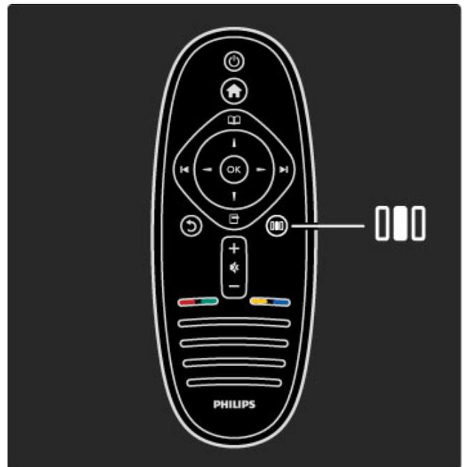
Відкриття або закриття **меню налаштування** **000**
