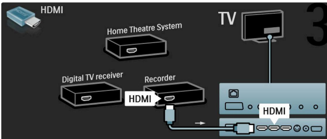
Потім за допомогою кабелю HDMI під'єднайте систему домашнього кінотеатру до телевізора.
