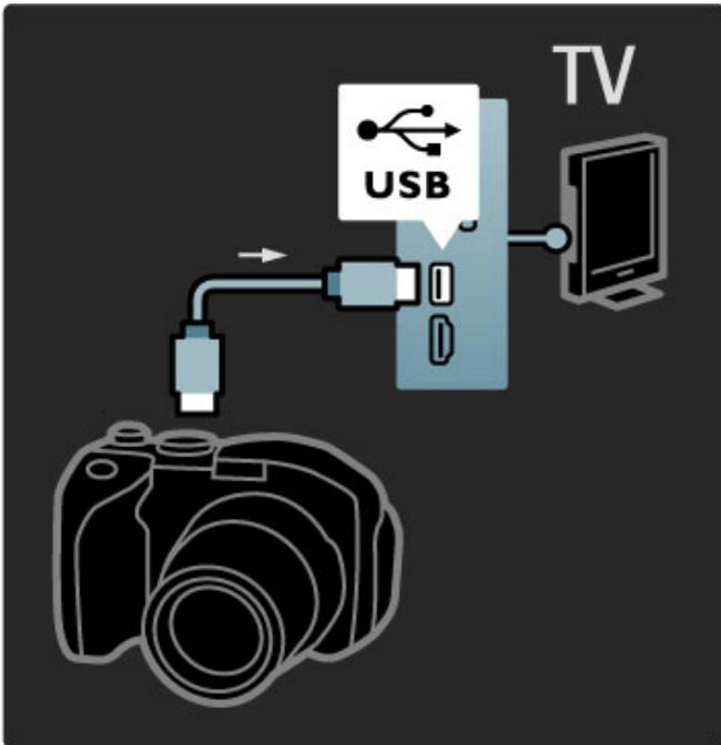
Якщо список із вмістом фотоапарата не відкривається автоматично, можливо, фотоапарат потрібно налаштувати на передачу вмісту за допомогою протоколу передачі зображення PTP. Читайте посібник користувача для цифрового фотоапарату.
