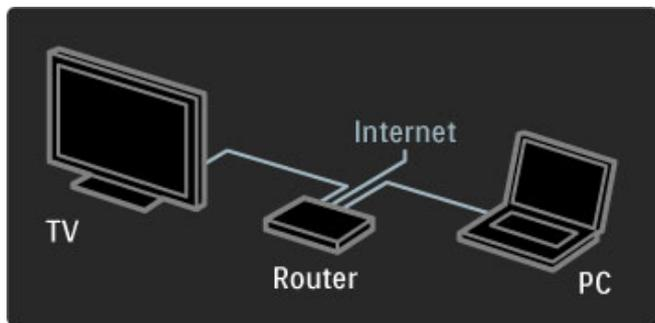
Якщо Ви бажаєте вибрати дротове під'єднання до маршрутизатора, потрібен мережевий кабель (Ethernet).
