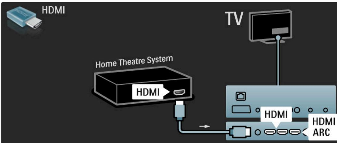
Якщо Ви не використовуєте з'єднання HDMI-ARC, додайте цифровий аудіокабель (цифровий коаксіальний).
