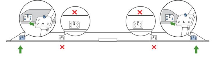
\*将底座按照图示对齐放置(注意区分左右支撑), R、L在底座上有标识。
