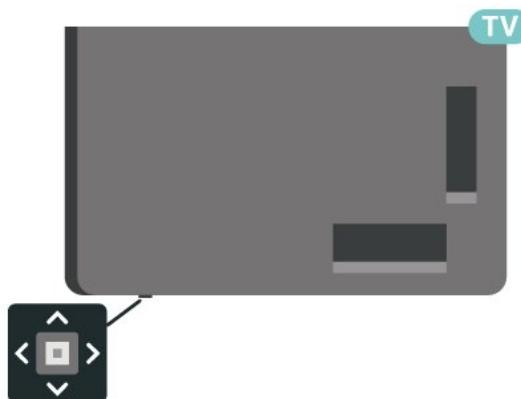
**1** - При включен телевизор натиснете клавиша с джойстик в долната част на телевизора, за да извикате базовото меню.
