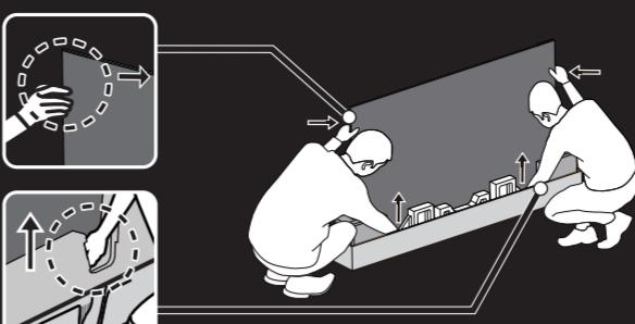
4 竖直移动屏幕，确保平整台面上无杂物后铺上软布，屏幕朝下平放在桌上。
