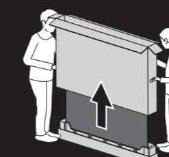
3 两人协作，轻扶机器两侧，从背面托住机器底部竖直抬机。
