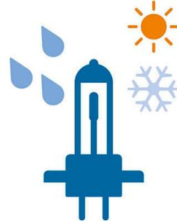
Seules des lampes en verre quartz (filament 2 650 °C, verre 800 °C) peuvent résister à d'importants chocs thermiques, par exemple lorsqu'une goutte d'eau froide entre en contact avec une lampe brûlante alors que vous conduisez avec un phare cassé.
