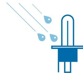
Solo una lámpara encendida fabricada con cristal de cuarzo (filamento a 2650 °C, cristal a 800 °C) puede soportar cambios bruscos de temperatura; por ejemplo, resiste sin explotar el goteo de agua fría sobre el cristal caliente de la lámpara, algo que puede suceder al conducir con una lámpara delantera rota y si hay agua en el entorno.
